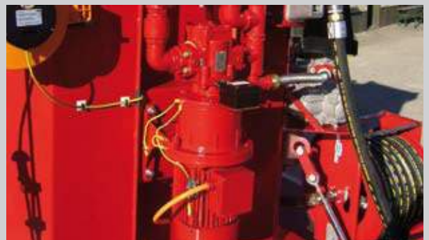
A) Robuste Kraftstoffpumpe 50 Ltr./min.
