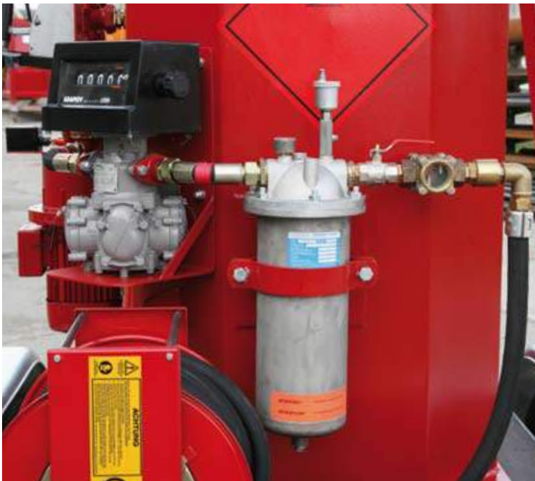
C) Kraftstofffilter mit Wasserabsorber und Entlüfter
