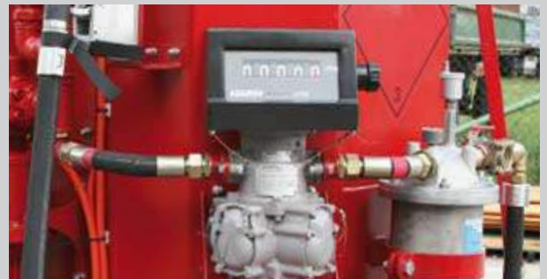
B) Zählwerk eichfähig, geeignet für Flugkraftstoffe
