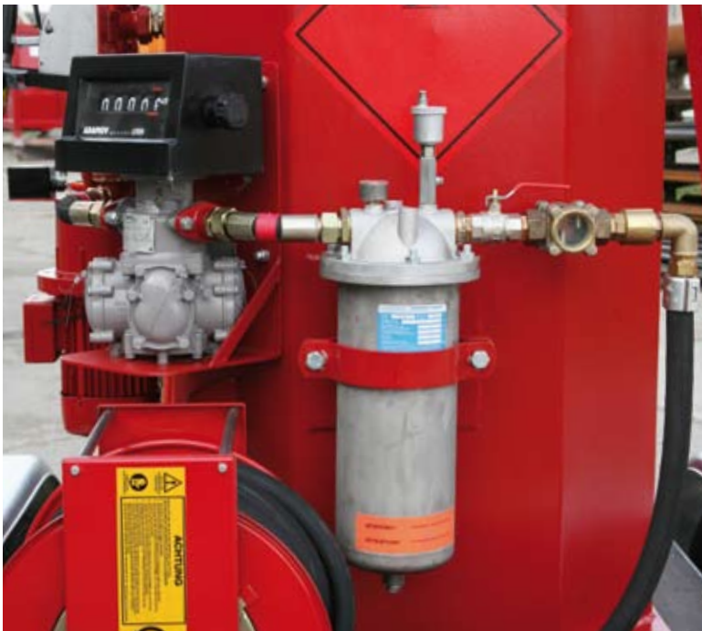
C) Kraftstofffilter mit Wasserabsorber und Entlüfter
