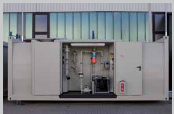
Zapfanlage längsseitig mittig integriert
