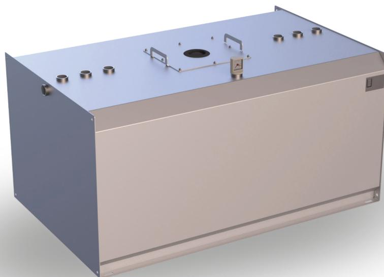
Der TTE-C-VA dient als Tagestank für die Versorgung von Aggregaten mit Kraftstoff, Urea oder Schmieröl. Der TTE-C-VA wird auch als Vorlagetank bezeichnet. Er erfüllt aufgrund seines Aufbaus und seiner Ausstattung die Anforderungen für den Einsatz an Notstromanlagen gem. VDE 107/108. Er ist sowohl für das Aufstellen in Gebäuden als auch in Anlagencontainern geeignet. Die Aufstellfläche muss eben, tragfähig und als Auffangwanne ausgebildet sein. Ist bauseitig kein
